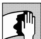
Очистите поверхность: перед нанесением Autosurfacer HB удалите любые загрязнения, используя соответствующие обезжириватели.
