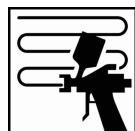
Нанести один легкий слой на всю зашлифованную поверхность. Нанести второй и третий слои внутри каждого предыдущего слоя. Если деталь грунтуется целиком, нанесите на всю деталь 2-3 слоя в зависимости от требуемой толщины пленки.
