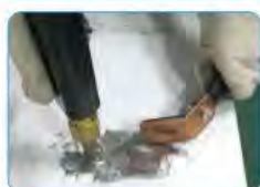
Подключение массы (рис.1)
