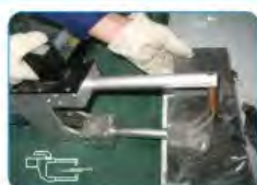
Точечная сварка пневматическими клещами
