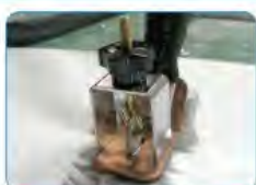
Подключение массы (рис.2)
