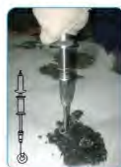
Работа обратным молотком с использованием шайб
