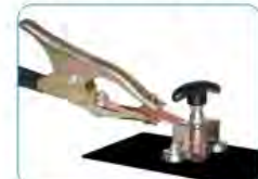
Подключение зажима «массы»
