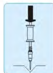
Работа обратным молотком с использованием иглы
