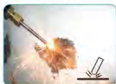
Прогрев угольным электродом
