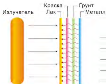
Принцип работы инфракрасного излучателя
